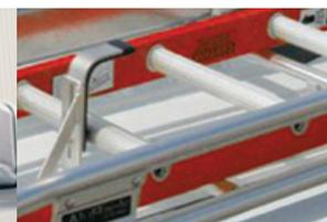
Le système S-Clamp garantit une fixation facile et sans attache de l'échelle sur la galerie.
