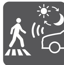
**PRE-COLLISION SYSTEM (PCS) avec détection des piétons** Dès que le système décèle un risque de collision, le conducteur est prévenu par des signaux acoustiques et optiques, et l'assistance au freinage est activée. Lorsque le conducteur ne réagit pas à temps, le véhicule freine automatiquement afin d'éviter une collision ou d'en atténuer les effets.
