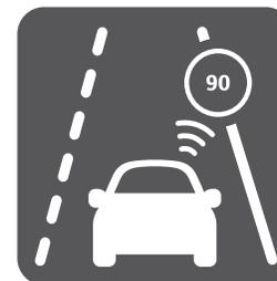
**ROAD SIGN ASSIST (RSA)** Le système scanne les panneaux de signalisation routière et affiche à l'écran les principales informations comme les limitations de vitesse. De plus, des avertisseurs optiques et acoustiques préviennent le conducteur si celui-ci ne respecte pas les dispositions légales.
