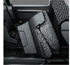
Si vous devez transporter plus de bagages que d'ordinaire, les sièges rabattables à la verticale – de série sur l'exécution Shuttle – permettent d'exploiter chaque centimètre disponible.
