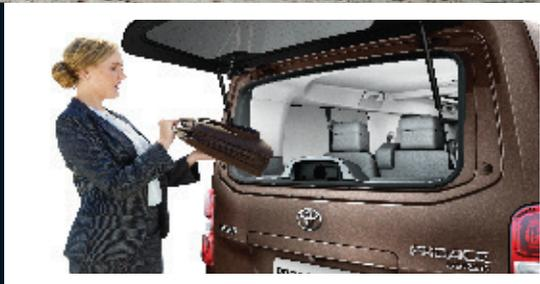
Équipant de série les exécutions MPV et VIP, la lunette arrière ouvrante offre un accès rapide et aisé au compartiment à bagages sans devoir ouvrir le hayon.
