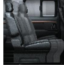
Profitez de la flexibilité de l'espace de chargement ou augmentez par exemple l'espace aux jambes grâce aux sièges coulissants montés sur rails, qui sont disponibles sur les exécutions MPV et VIP.
